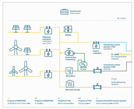
The energy flow in the ENERTRAG Verbundkraftwerk®
